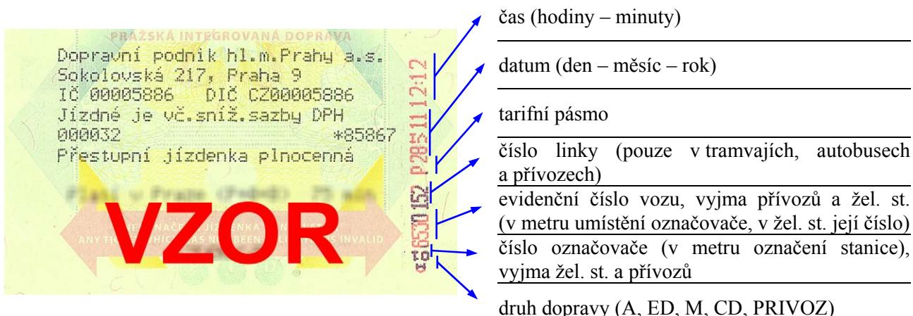
Označovací pole jízdenek ze stacionárních automatů je tvořeno chemicky reagujícími proužky, které způsobí dvoubarevné zabarvení vytiskněných údajů po označení. Změna barvy je patrná již 30 sekund až 1 minutu po označení, k úplnému vybarvení dochází přibližně za 5 minut. Tyto informace se vztahují ke všem jízdenkám vydávaným v předprodeji.
